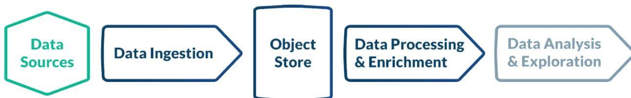
Figura 2 – Blocchi logici architetturali di cui è composto un TDL.
